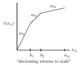
replace  $x_{ij}$  by 3 variables  $r_{ij}, s_{ij}, t_{ij}$
